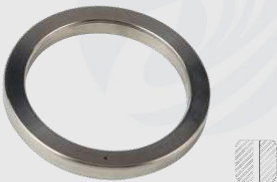
ガスケットの断面は方形で、四辺に斜角があり、中央に圧力平衡孔が開いている。ガスケットを正しく取り付けたら、フランジが面と向かって圧力接触しないようにします。このガスケットは2000 Psiまでの圧力を封止するように設計されたシステムである。
