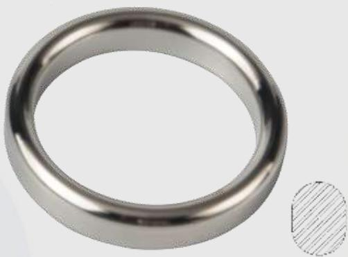
ガスケット断面は楕円形であり、ガスケットの円弧面によるフランジ溝への線接触であり、シール効果を発揮する。楕円形または平底溝のあるフランジに適しています。
