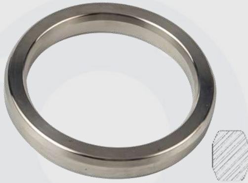
ガスケット断面は八角形であり、ガスケットの4つの斜面によってフランジ溝の面に接触し、シール効果を発揮する。平底溝のあるフランジに適しています。楕円形リングマットに比べて、八角型リングマットはシール効果が良い。
