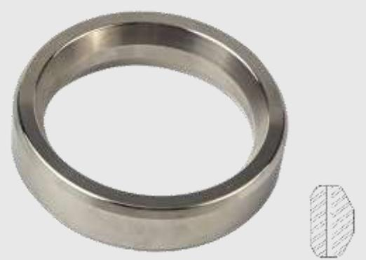
このガスケットはR形ガスケットの改良型であり、断面設計はパイプ内圧を利用してシール性能を高めることができる。石油掘削プラットフォームに適しています。
