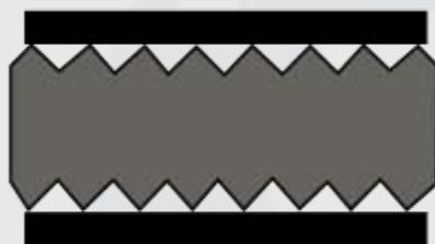
このタイプのカンプロファイルガスケットは、狭いシール面に使用され、はめ込み形と溝形フランジに適している。
