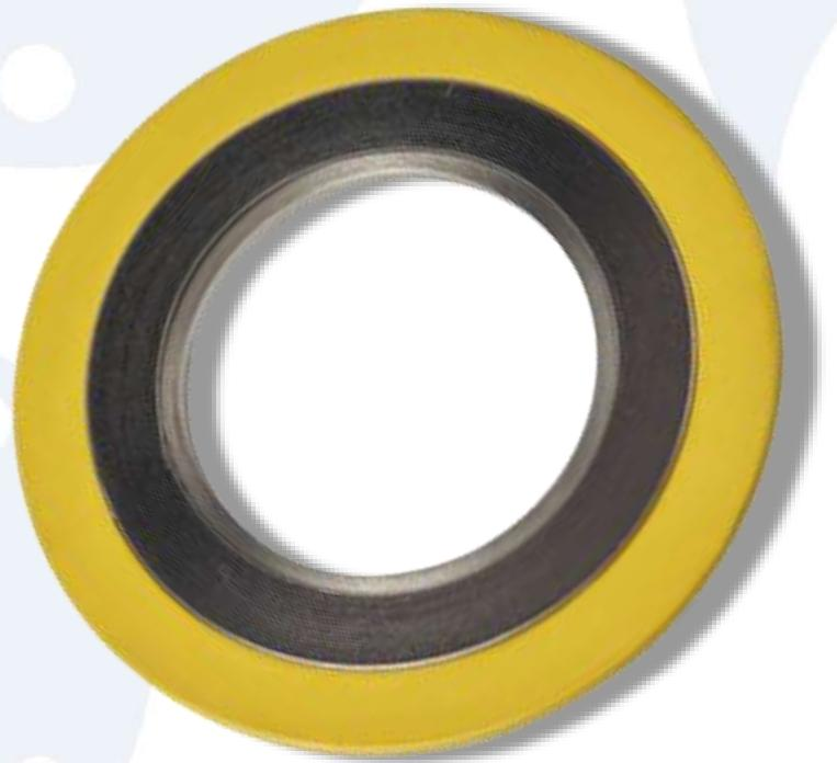
うず巻形ガスケットは予備成形された鋼帯とシール帯材を交互に巻回し、鋼帯はガスケットに十分な強度と復元力を持たせ、シール帯材はシール作用を果たす。その上で、金属の内輪と外輪を追加し、ガスケットが押圧された後に変形、散架しにくい。一方で、位置決め機能を提供し、現場での取り付けを容易にする。
